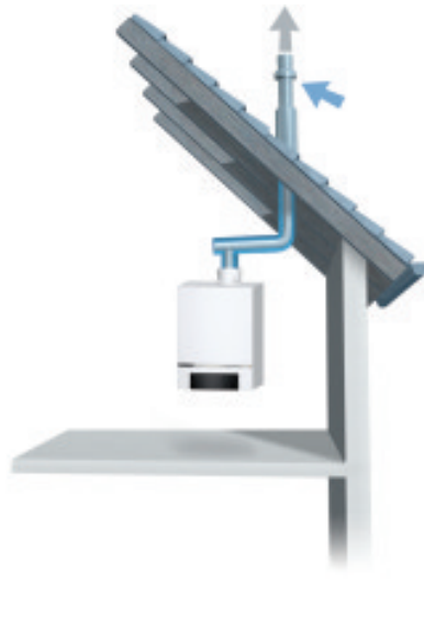
Primer namestitve z zajemom zraka izven prostora, z uporabo koaksialnega dimovodnega sistema
