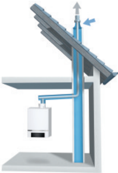
Primer namestitve z zajemom zgorevalnega zraka izven prostora in odvodom dimnih plinov po obstoječem dimniku, v katerega je vstavljena dimovodna cev (dimnik je primeren za dovod zraka)
